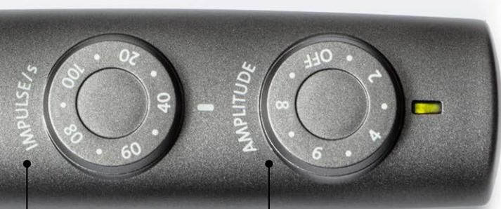
La molette « Impulse/s » permet de régler la fréquence des impulsions entre 10 et 100 Hz, en fonction de l'indication et des recommandations du Guide de traitement.
