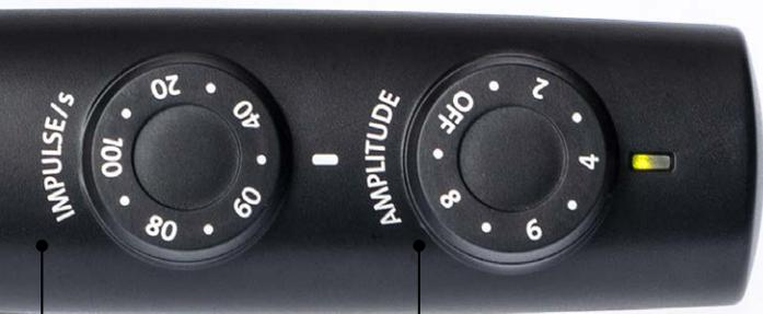
La molette « Impulse/s » permet de régler la fréquence des impulsions entre 10 et 100 Hz, en fonction de l'indication et des recommandations du Guide de traitement.
